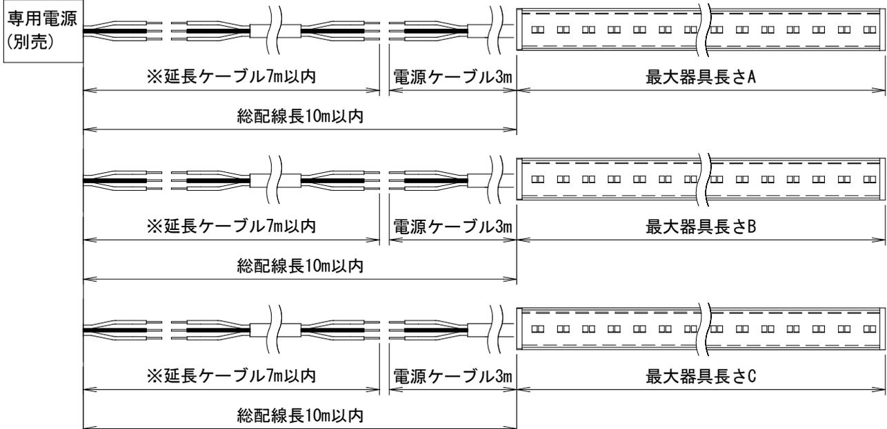
※電源ケーブルを延長する際は、AWG16以上の太さの電線をご使用ください。
