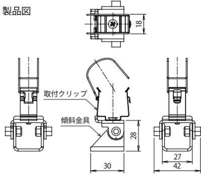
取付金具セットの寸法・稼働範囲
